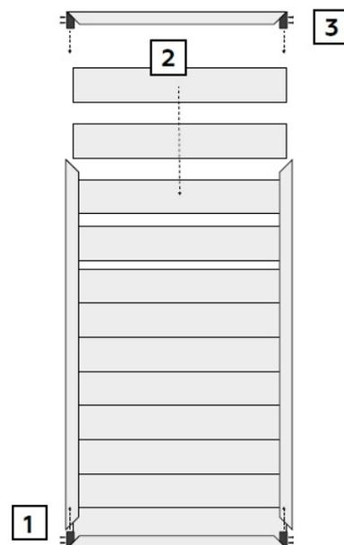
Um das Tor fertigzustellen, montieren Sie im letzten Schritt die Drückergarnitur mittels des beiliegenden Montagematerials und die Ladenbänder mit Hilfe der Schrauben, Unterlegscheiben und Kugelkopfmuttern an dem Tor.
